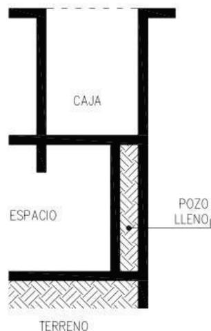
El fondo descrito en los Apartados (I) y (II), en contacto con la tierra será de albañilería u hormigón con aislamiento hidrófugo. Las guías del coche alcanzarán el fondo de la caja.
