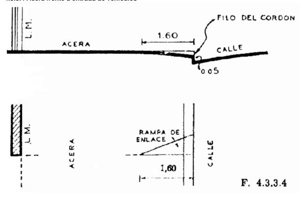
El solado que sirve de entrada de vehículos cubrirá totalmente el área comprendida por el ancho de la acera y la amplitud de esa entrada. Ese solado se ejecutará con materiales iguales al resto de la acera cuando sirva a vehículos livianos. Para vehículos de carga, se hará con granitullo, hormigón o bien materiales asfálticos; en el primer caso las juntas se tomarán con asfalto.
